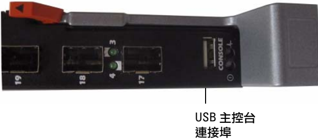
圖 1-4. PowerConnect M8024-k USB 主控台連接埠
