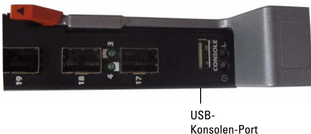
Abbildung 1-4. PowerConnect M8024-k USB-Konsolen-Port
